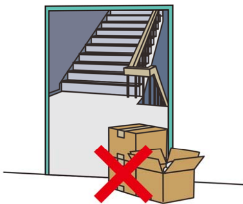
● 避難通道不可堆放雜物
