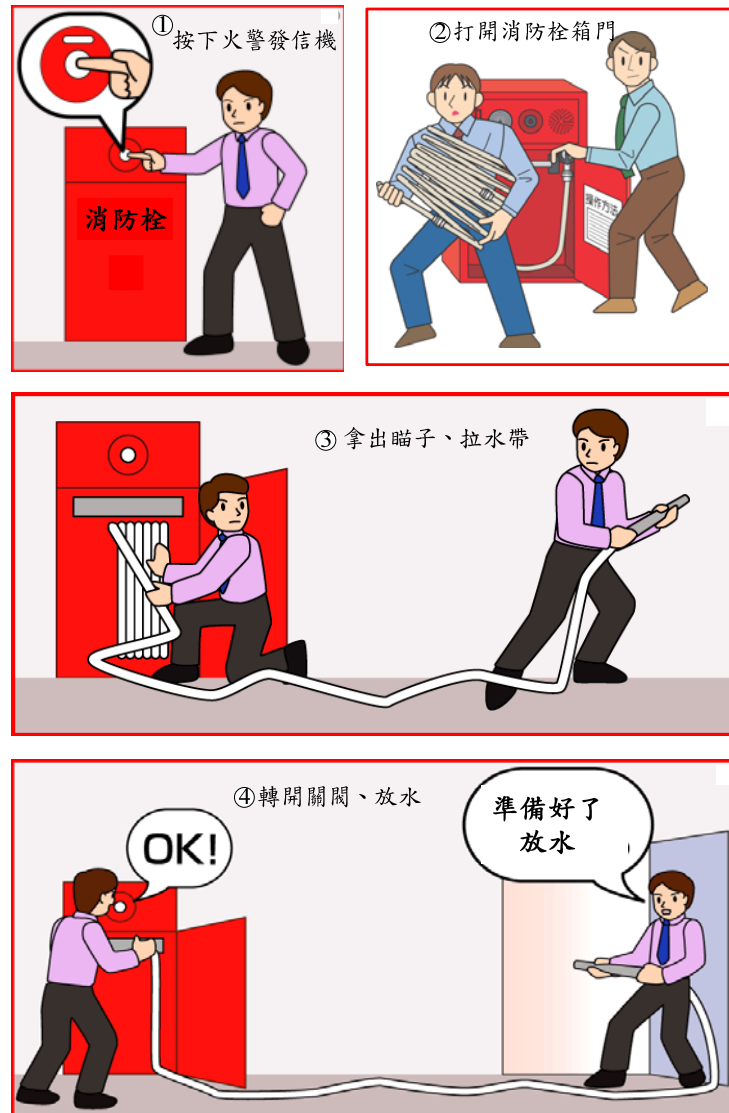
圖 2-21 第 1 種消防栓操作方法（資料來源：同註 1）
